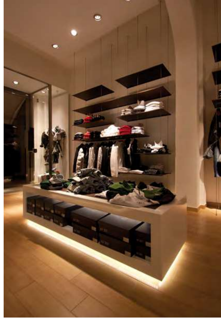
Saglimbeni boutique (Cecina -LI) Progetto: Interior Designers Davide Gori & Alessandra Tanteri • Allestimento in COR-TEN verniciato • Sistema di mensole sospese con cavi d'acciaio • Parete e totem espositivi in COR-TEN
